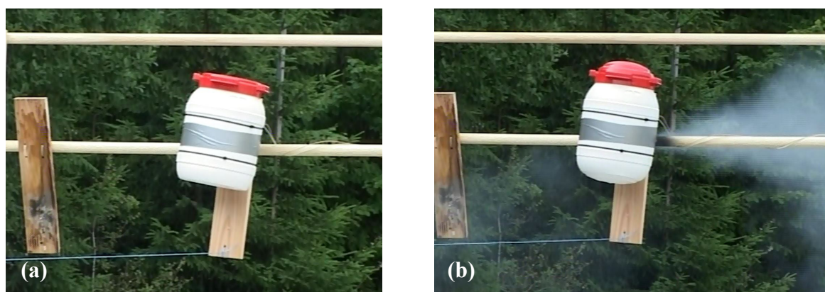
Abb. 4. “Shake and bake” Ansatz in einem Schraubdeckelgefäß. Ausgangssituation (a) und Ausbauchung von Boden und Deckel sowie Abblasen des durch die Umsetzung entstandenen Überdrucks (b).
