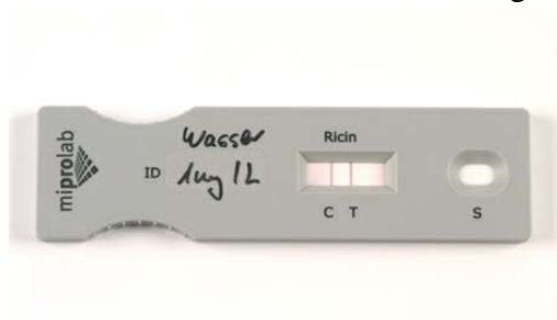
Abb. 3. Positiver Lateral Flow Assay für rizinhaltiges Wasser bei einer Konzentration von 1 mg/L: Kontrollbande (C) und Toxin-Bande (T) gleich intensiv, Bildrechte [4].
